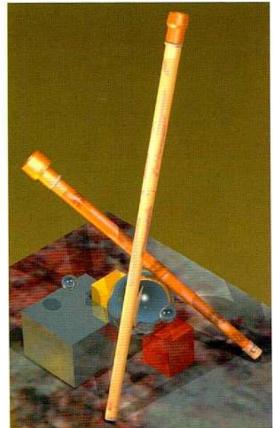
Dos telescopios construidos por Galileo en 1609. El diámetro de las lentes de estos ejemplares no superan los tres centímetros. Posteriormente fabricó decenas de ellos mucho más perfeccionados.
