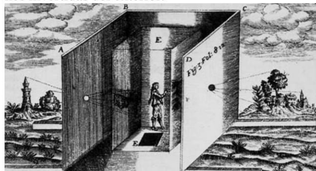
Cámara oscura utilizada en pintura (Athanasius Kircher 1646).
