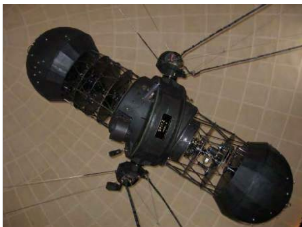
Planetario Municipal "Germán Barbato": Instrumento modelo Spitz B de aproximadamente 3,50 m de largo. Los hemisferios estelares tienen un diámetro de 91,5 cm (Foto cortesía O. Méndez).
