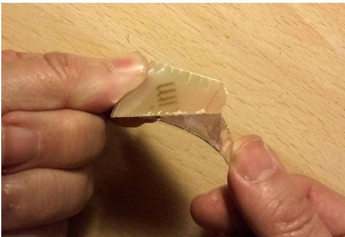
Fig. 30. Doblando el trozo de DVD se separa la parte plateada de la que se usa de red
