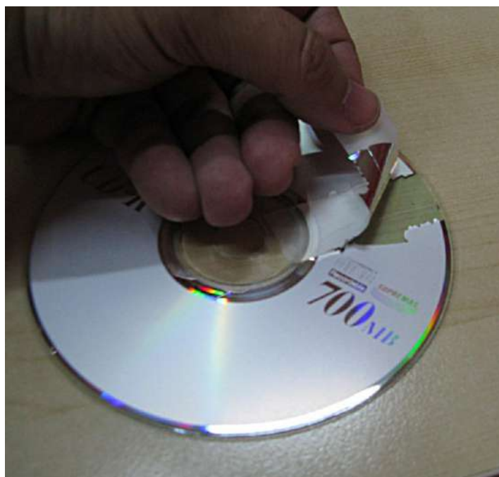
Fig. 23. Retirando la capa metálica del CD con cinta adhesiva.
