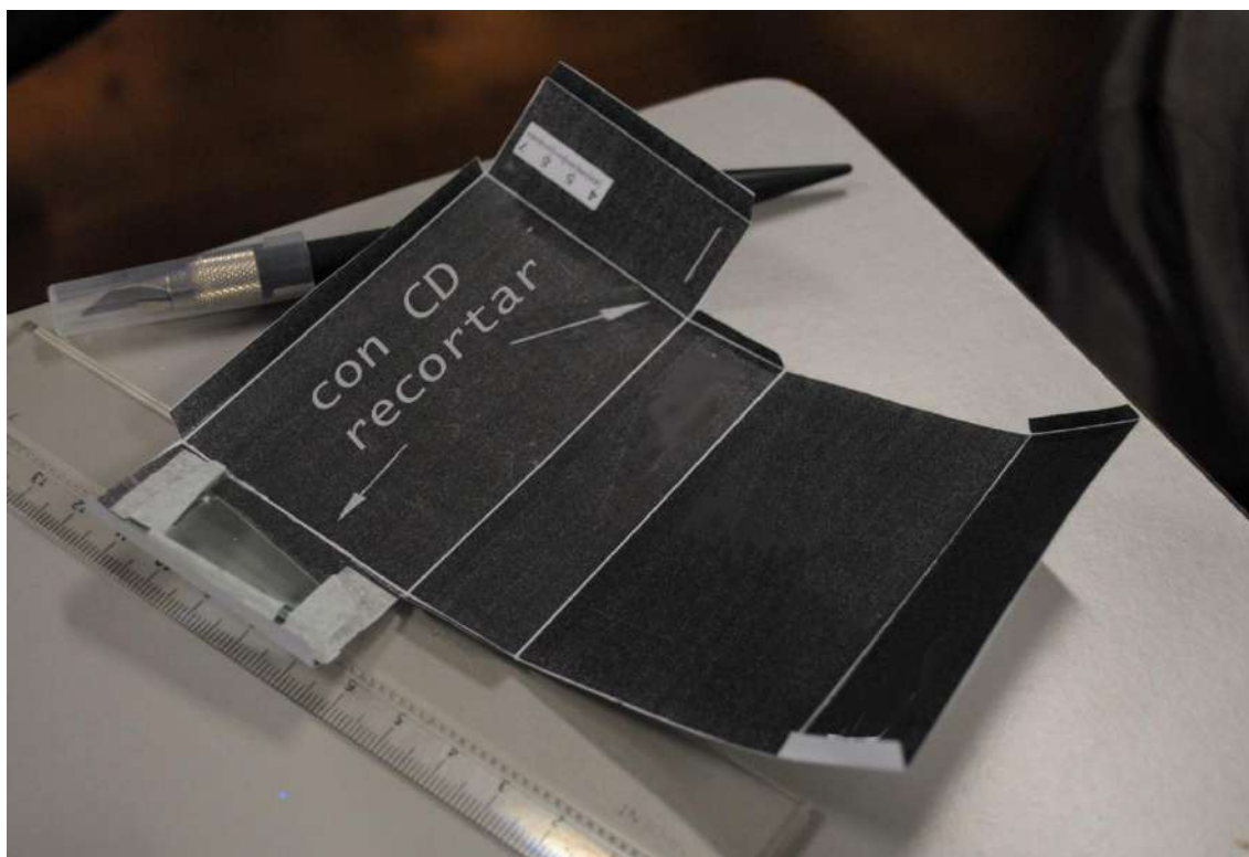
Fig. 25. Recortar y armar el espectroscopio, dejando la parte negra por dentro
