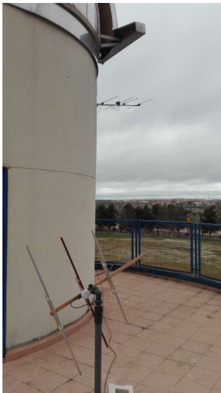
Izquierda: La estación del Aula de Astronomía de Fuenlabrada, en una configuración experimental, con una antena de construcción propia abajo. Derecha: Eco de radar de un meteoro captado por la estación del Aula de Astronomía de Fuenlabrada
