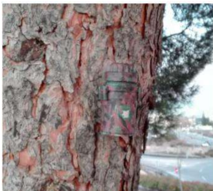
Cámara de PVC de 40 mm de diámetro instalada en el tronco de un pino. Está pintada para hacerla menos visible.
