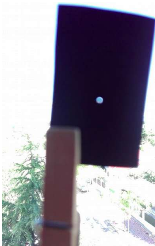
Fig. 5 Chapa de aluminio de lata de refresco con estenopo
