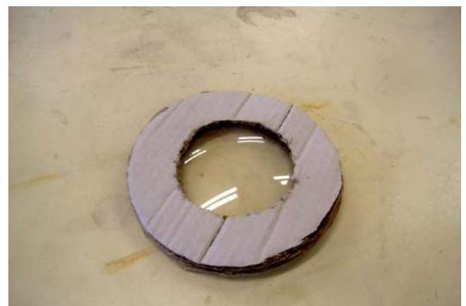
Fig. 7: Lente entre dos coronas circulares de cartón
