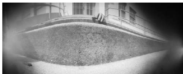
Fig. 10 Imagen tomada con cámara estenopeica cilíndrica. Esquinas sin iluminar, líneas horizontales curvadas y todo enfocado.
