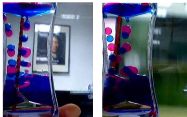
A la izquierda, el aparato parado, con gravedad: las gotas son deformadas. A la derecha, en caída libre: las gotas se detienen y además son totalmente redondas
