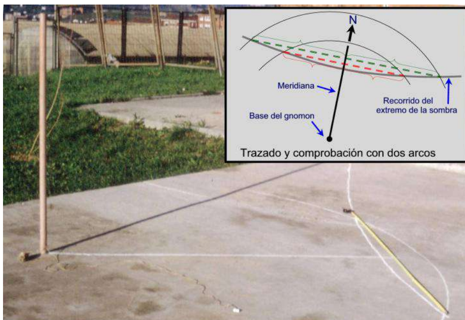
Figura 2. Trazando un arco con centro en la base del gnomon cortará en dos puntos a la trayectoria del extremo de las sombras, y uniendo el punto medio entre de esos dos con la base del gnomon se obtiene la meridiana. Para mejorar la precisión o confirmar la exactitud del resultado puede repetirse el trazado con arcos de otros radios.
