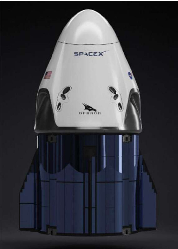
Cápsula Dragon Crew. La mitad inferior lleva carga y está recubierta con placas solares fotovoltaicas para suministrar energía
