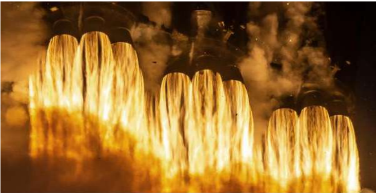
El Falcon Heavy lleva 3 x 9 motores Merlin
