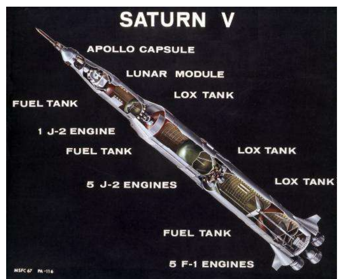
Imagen 8. Cohete Saturno V, con sus tres fases. Casi todo el volumen lo ocupaba los tanques de fuel o de LOX.
