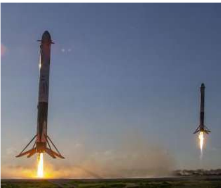
La primera etapa del Falcon Heavy dispone de 27 motores Merlin. Cada una de las tres partes aterriza con sus 4 patas abatibles. Las dos laterales lo hacen sobre tierra, y la central lo hace en una plataforma flotante, en el océano. Así pueden ser reutilizadas.
