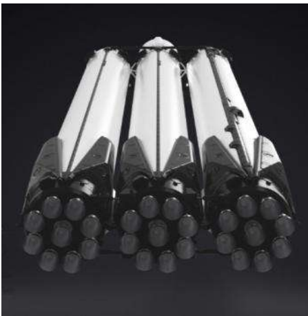
La primera etapa del Falcon Heavy dispone de 27 motores Merlin. Cada una de las tres partes aterriza con sus 4 patas abatibles. Las dos laterales lo hacen sobre tierra, y la central lo hace en una plataforma flotante, en el océano. Así pueden ser reutilizadas.
