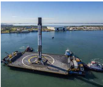
La primera etapa del Falcon Heavy dispone de 27 motores Merlin. Cada una de las tres partes aterriza con sus 4 patas abatibles. Las dos laterales lo hacen sobre tierra, y la central lo hace en una plataforma flotante, en el océano. Así pueden ser reutilizadas.
