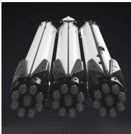
La primera etapa del Falcon Heavy dispone de 27 motores Merlin. Cada una de las tres partes aterriza con sus 4 patas abatibles. Las dos laterales lo hacen sobre tierra, y la central lo hace en una plataforma flotante, en el océano. Así pueden ser reutilizadas.
