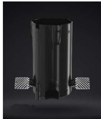
Inter-etapa, con aletas hipersónicas que le ayudan en la caída. Esas aletas también van en la primera etapa. Funcionan bien en velocidades subsónicas e hipersónicas, pero no justo a la velocidad del sonido.
