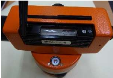
Fig. 59. Nivel esférico calado y el nivel tubular no
