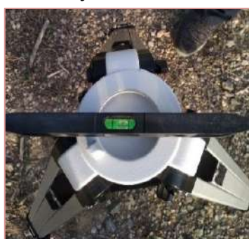
Fig. 52. Calado de la burbuja del nivel en base trípode
