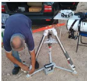
Fig. 51. Realizando la puesta en estación del telescopio con nivel de obra.
