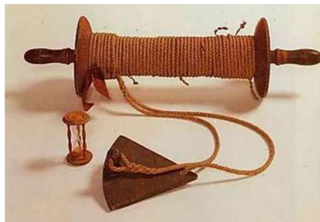
Figura 1: Corredera y ampolleta para medir la velocidad del barco en nudos.
