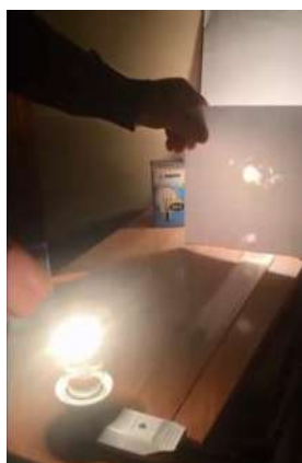
Fig. 10 Fotómetro de mancha de aceite
