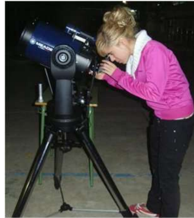
Telescopio Meade LPX90GPS de 20 cm de diámetro y 2000 mm de distancia focal.
