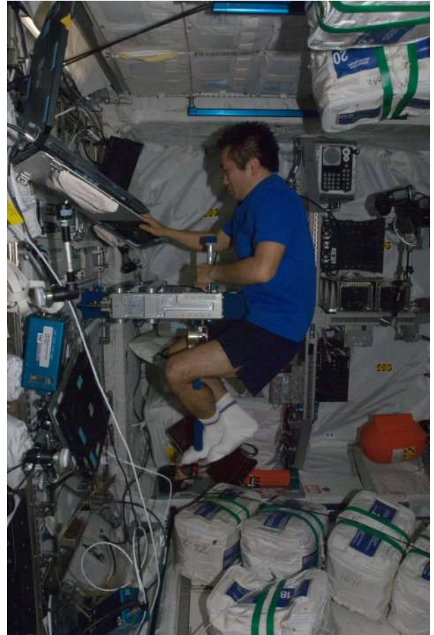
Fig.4. Astronauta midiendo su masa en la ISS. El dispositivo de medición de la masa corporal utiliza las propiedades del movimiento armónico para determinar la masa de los astronautas. Como sabemos, un astronauta de mayor masa vibra más lentamente que otro de menor masa. Cortesía ESA.
