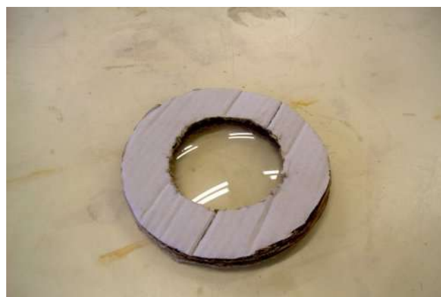
Fig. 7: Lente entre dos coronas circulares de cartón.
