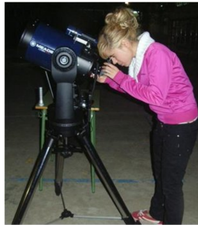
Telescopio Meade LPX90GPS de 20 cm de diámetro y 2000 mm de distancia focal
