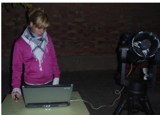
Webcam adaptada al foco primario del telescopio y conectada al portátil
