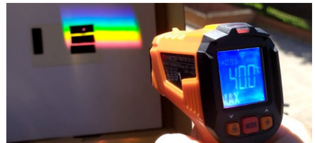
Experimento de Herchel para detectar la radiación infrarroja, con un termómetro digital.
