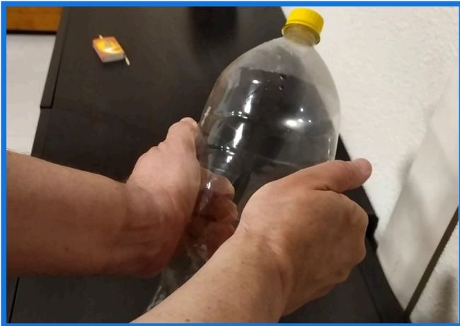
Fig. 4. Al producirse la expansión adiabática, se forma la nube en el interior.
