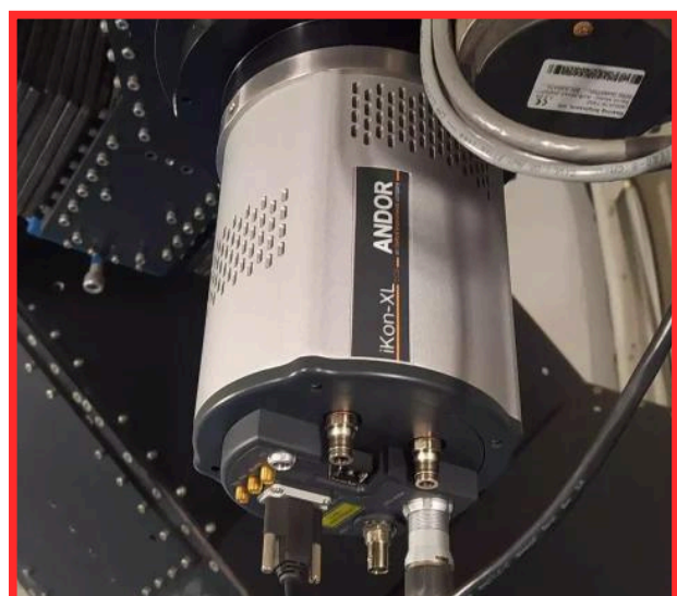
La cámara CCD es una Andor iKon XL, con un sensor 4kx4k.
