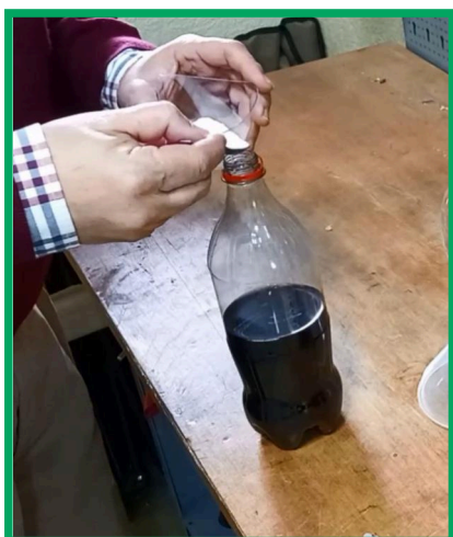
Fig. 3. Al echar sal o azúcar, el \text{CO}_2 rebosa, dejando la botella llena de ese gas, que, al ser más pesado que el aire, no se escapa.
