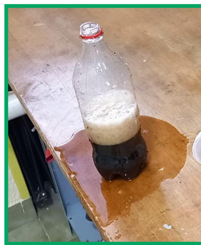
Fig. 3. Al echar sal o azúcar, el \text{CO}_2 rebosa, dejando la botella llena de ese gas, que, al ser más pesado que el aire, no se escapa.
