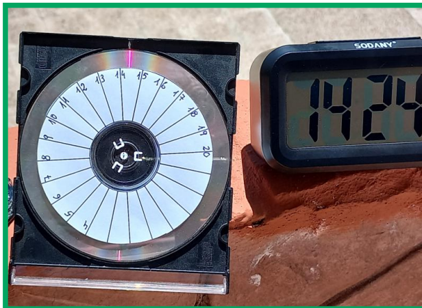
Fig. 12. En el mediodía solar, el reflejo está justo en la marca blanca superior de la caja. El día de la foto se produjo realmente a las 14:21. La precisión es notable.
