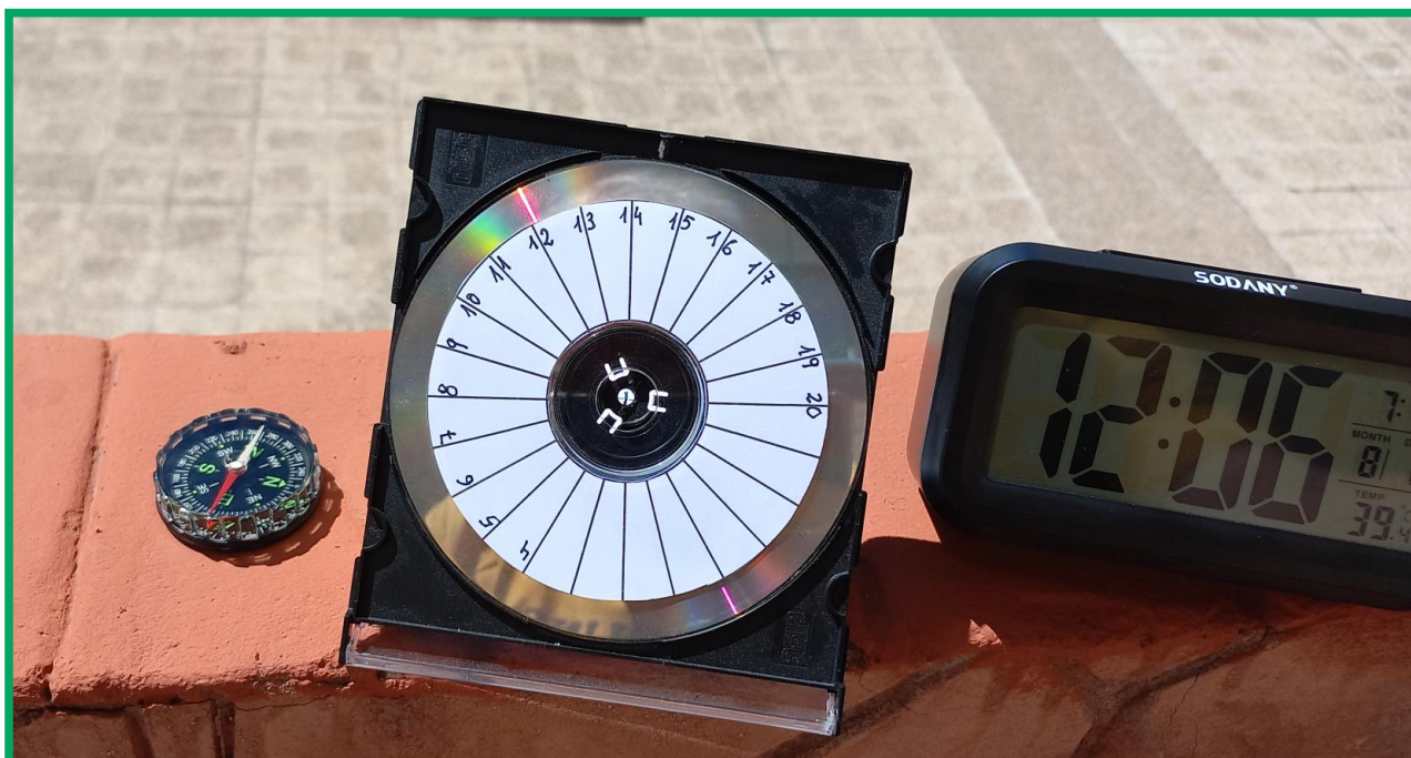
Fig. 9. Se sitúa el dvd con el mediodía solar (las 14 h en verano, las 13 h en invierno) coincidiendo en la marca blanca del borde de la caja.
