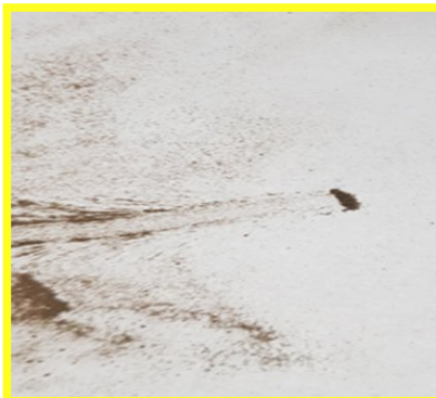
Fig. 8a, 8b y 8c. Separamos las partículas metálicas con un imán bajo el papel. Tiramos el resto.
