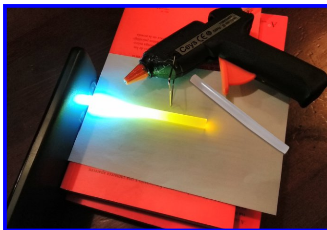
Fig 5. La barra de silicona de una pistola de termofusión dispersa los azules y deja la luz amarillo-rojiza.
