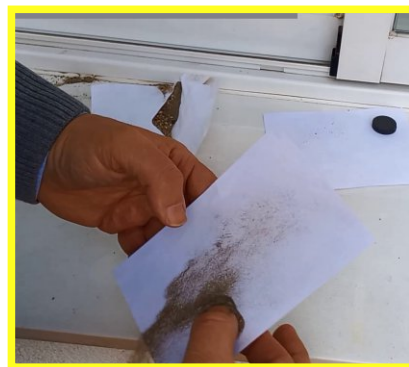
Fig. 8a, 8b y 8c. Separamos las partículas metálicas con un imán bajo el papel. Tiramos el resto.
