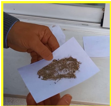
Fig. 8a, 8b y 8c. Separamos las partículas metálicas con un imán bajo el papel. Tiramos el resto.
