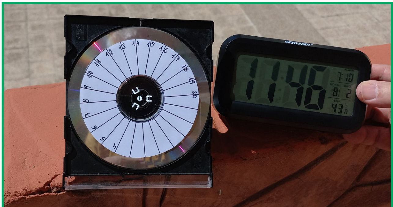
Fig. 10. Nos situamos enfrente del DVD, de tal forma que veamos por el orificio central la cruz dibujada en la tapa blanca. El reflejo nos da la hora.
