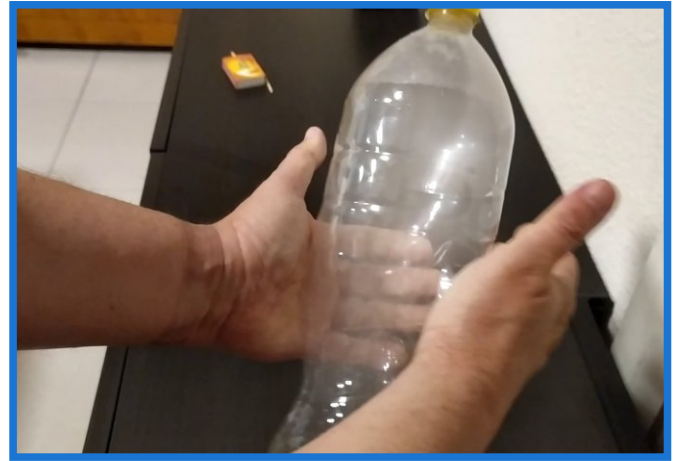
Fig. 4. Al producirse la expansión adiabática, se forma la nube en el interior.
