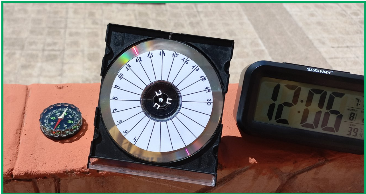
Fig. 9. Se sitúa el DVD con el mediodía solar (las 14 h en verano, las 13 h en invierno) coincidiendo en la marca blanca del borde de la caja.
