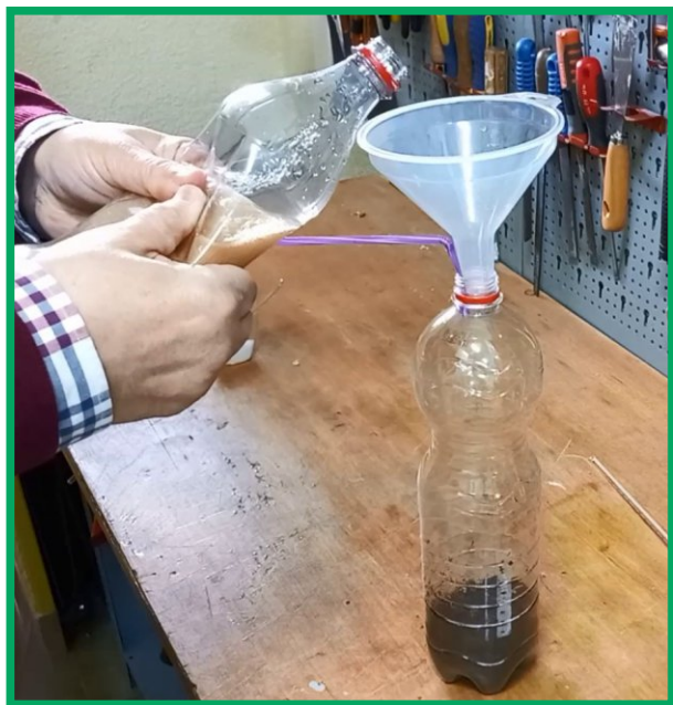
Fig. 4. Vertemos el \text{CO}_2 en una botella con tierra. Se deja salir el aire de dentro con una pajita.
