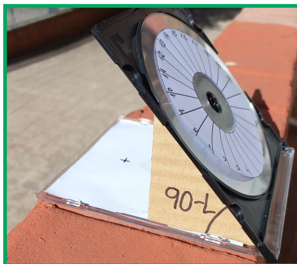
Fig. 4. Se pone el DVD formando un ángulo de la colatitud del lugar ( 90^\circ - \text{latitud} ), con la ayuda de dos triángulos.
