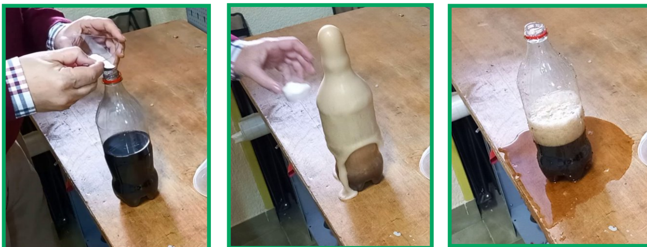
Fig. 3. Al echar sal o azúcar, el \text{CO}_2 rebosa, dejando la botella llena de ese gas, que, al ser más pesado que el aire, no se escapa.
