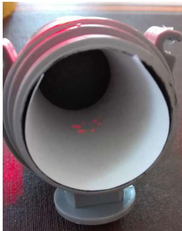
Fig. 7 Cámara de PVC de 32 mm de diámetro iluminada por una linterna roja de 6 LED. El papel no es fotográfico.
